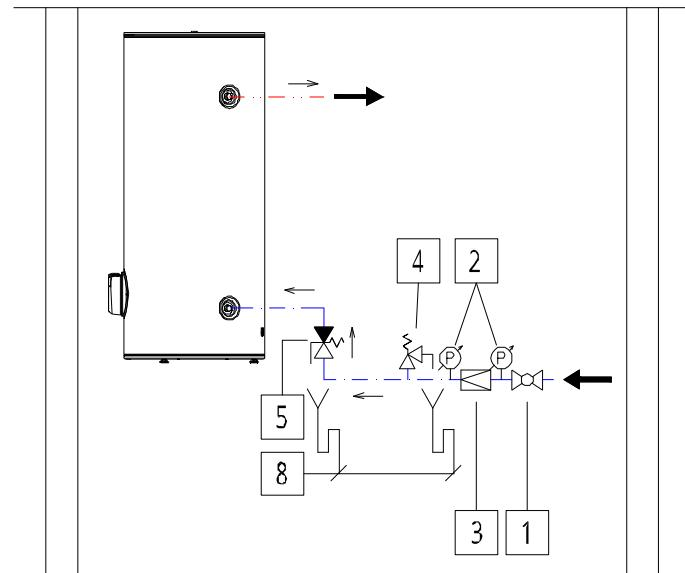
Forrázás elleni védelemmel ellátott hidraulikus bekötés - Hydraulic connection with anti-scalding protection - Hydraulischer Anschluss mit Verbrühschutz - Гидравлическое подключение с защитой от ошпаривания - Conexiune hidraulică cu protecție împotriva opăririi
