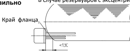
В случае фланцевых резервуаров, расположенных посередине, допускается только тип RUL.
