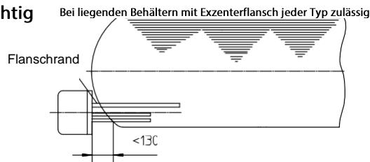
Bei liegenden Behältern mit mittigem Flansch ist nur der Typ RUL zulässig.
