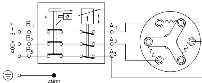
10.2.2 Átkötésre: 1 fázisú kapcsolási vázlat - Re-wiring: 1-phase circuit diagram - Für den Neuanschluss: 1-Phasen-Schaltplan - Переподключение: схема 1-фазного подключения - Re-conectare: schemă conexiune monofazică
